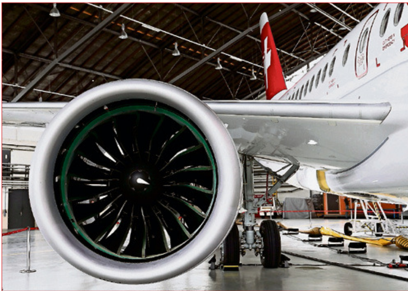
Die Pratt-&Whitney-Triebwerke der CS100, die ab 2016 für die Swiss im Einsatz steht, sind wegen eines zwischengeschalteten Getriebes leiser als bisherige Düsen. Die Hersteller versprechen 10 bis 15 Dezibel Lärmreduktion, was für das menschliche Gehör einer Halbierung entspricht. Bild: Sibylle Meier
